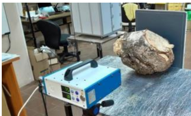
Рис. 4. Портативный рентгеновский аппарат РАП-120.
