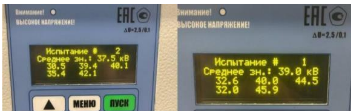
Рис. 3. Результаты испытания трансформаторного масла.
