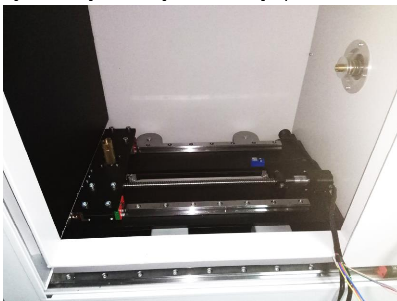
Рисунок 3. Томографическая приставка в рабочей камере рентгенодиагностической установки
