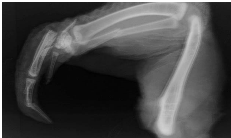
Рис. 1. Рентгеновский снимок куриного крыла, полученный с помощью катода на основе УНТ из ковара
