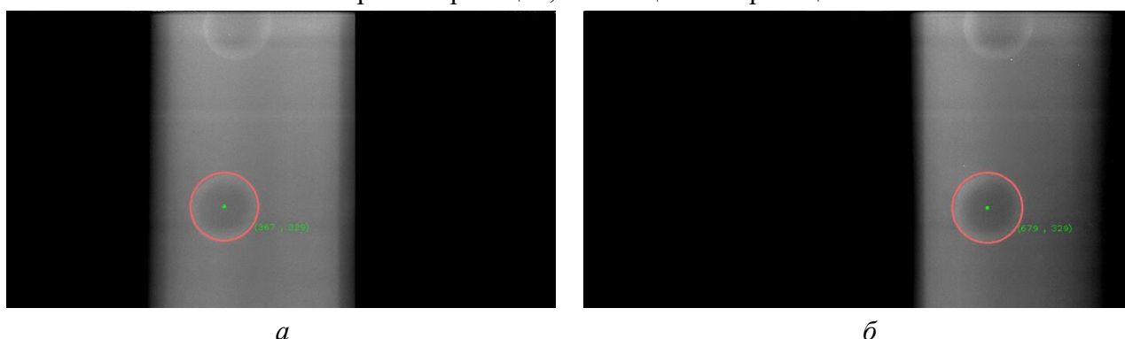
Рисунок 5 – Результат детектирования границ сварных соединений: а - прямая проекция, б -смещенная проекция
