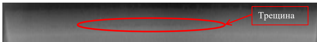
Рис. 5. Рентгеновское изображение конструктивно-подобного элемента в процессе лабораторного нагружения
