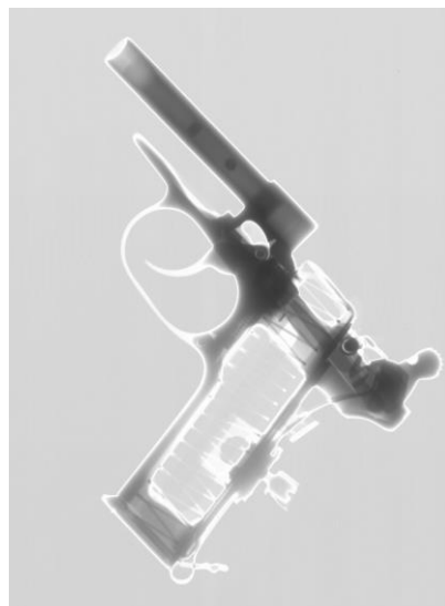
Рис 4. Снимок пистолета на котором виден высверленный ствол и пустая обойма
