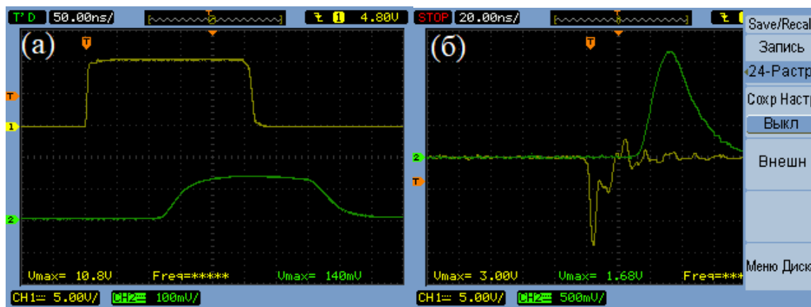
Рисунок 4. Осциллограмма излучения светодиода с ФЭУ ETL 9141В на нагрузке 51 Ом с предварительным усилителем для одиночного импульса (а) и для схемы с лавинным транзистором (б). (желтый – вход светодиода, зеленый – выходной сигнал ФЭУ)
