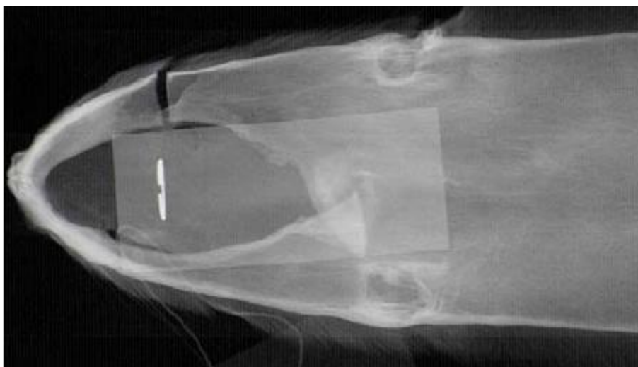
Рис. 3. Рентгеновское изображение меха норки, полученное при напряжении 20 кВ на рентгеновской трубке с TDI-детектором (Ajat)
