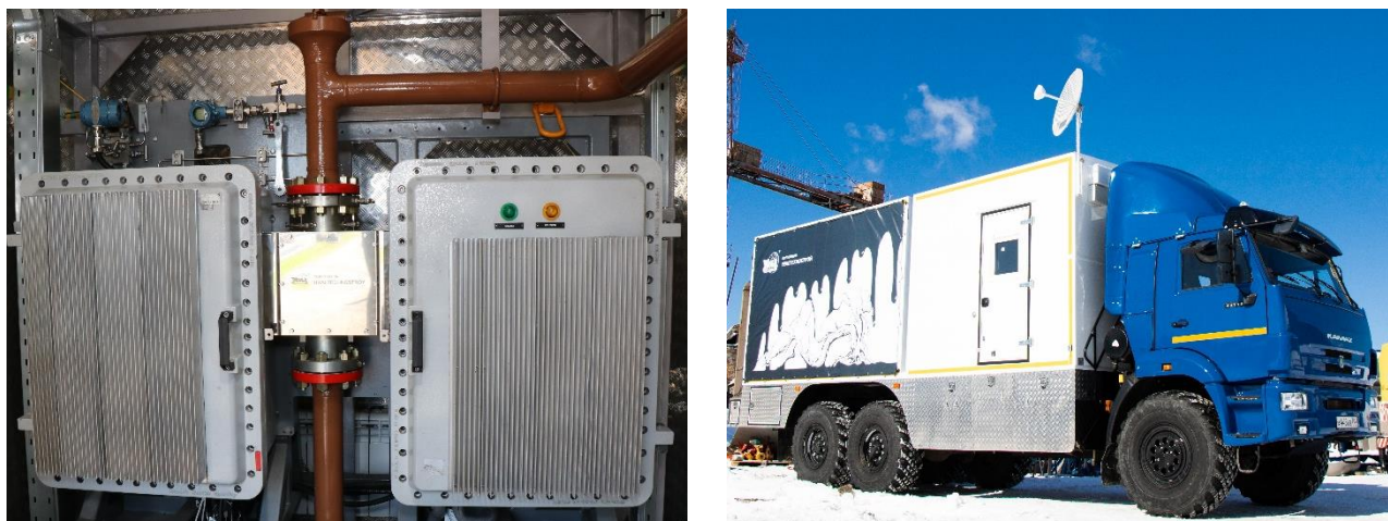
Рис. 2. Внешний вид многофазного расходомера Урал-МР в составе мобильной замерной установки (предсерийный образец).
