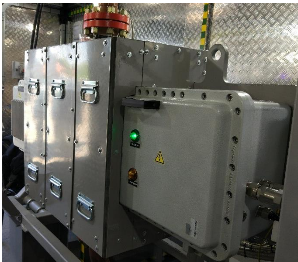
Рис. 1. Внешний вид многофазного расходомера Урал-МР в составе замерной установки на одно подключение (экспериментальный образец).
