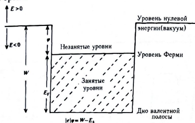
Рис. 3.4 — Энергетическая схема электронных уровней металла в модели свободных электронов. E_F — есть энергия Ферми; \phi — работа выхода; W — глубина потенциальной ямы, в которой находятся валентные электроны твердого тела.
