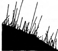
Рис. 4.3 – Нитевидные кристаллы на поверхности золоченых сеток \times 3000 [24]
